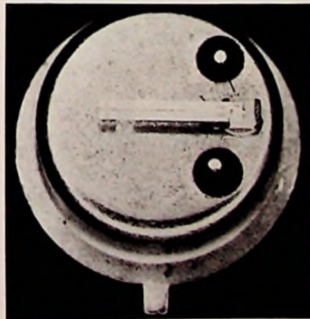
Bild 3. Stimmgabelquarz in einem geöffneten TO-5-Gehäuse (Bild: Statek-Enatechnik)
